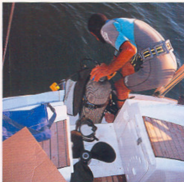
Een duiker gaat een nieuwe schroef monteren.
